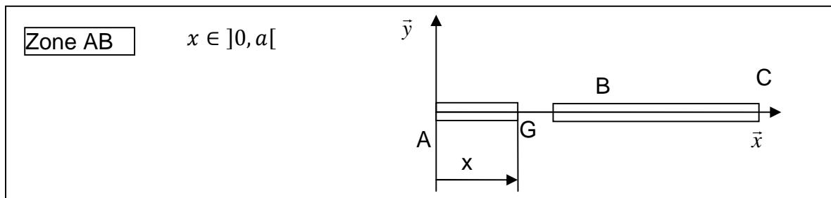
$$\{\tau_{coh}\}_G = - \left\{ \begin{matrix} F_A \vec{y} \\ 0 \end{matrix} \right\}_A = \left\{ \begin{matrix} -F_A \vec{y} \\ \overrightarrow{GA} \wedge (-F_A \vec{y}) \end{matrix} \right\}_G = \left\{ \begin{matrix} -F_A \vec{y} \\ x F_A \vec{z} \end{matrix} \right\}_G = \left\{ \begin{matrix} -\frac{(L-a)}{a} F \vec{y} \\ \frac{(L-a)}{a} F x \vec{z} \end{matrix} \right\}_G =$$
