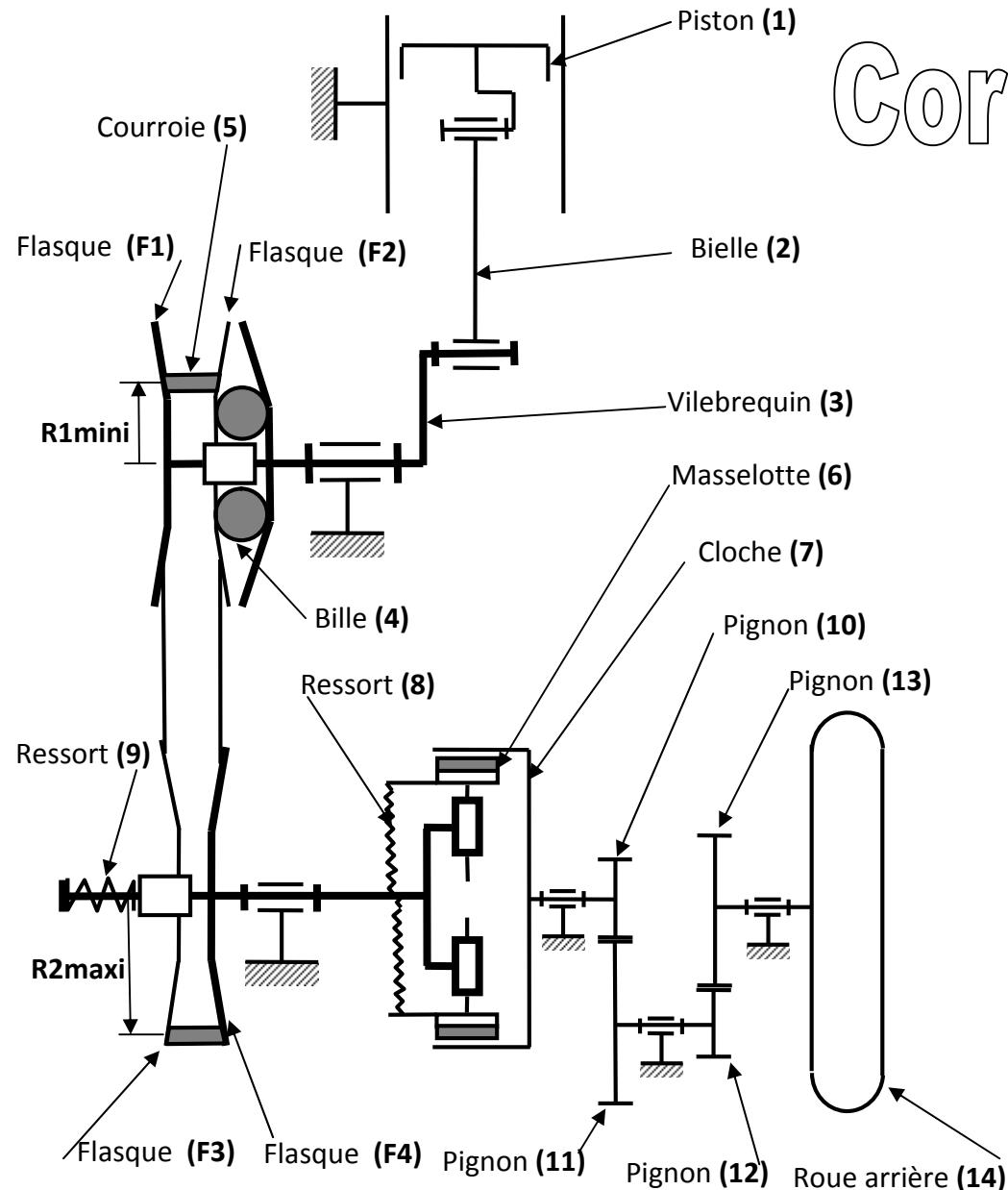
Figure 2 : Phase de glissement dans l'embrayage
